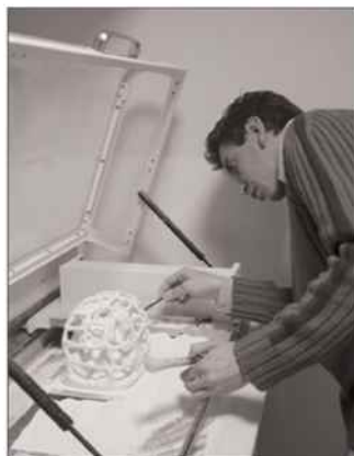
Sopra, sezione di una stampante «3DP», con a sinistra il pistone di alimentazione riempito dalla polvere di gesso, e a destra il pistone di costruzione, sul quale è posato il gesso in sezioni e su cui viene applicata la colla; a sinistra, estrazione e finitura di un modello
